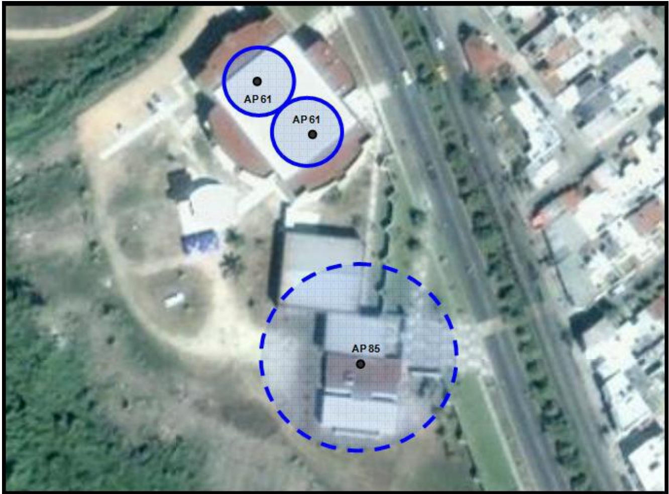
Figura 7. Distribución de equipos y antenas para el servicios de red inalámbrica en el Campus Manzanillo – Valle de las Garzas.
