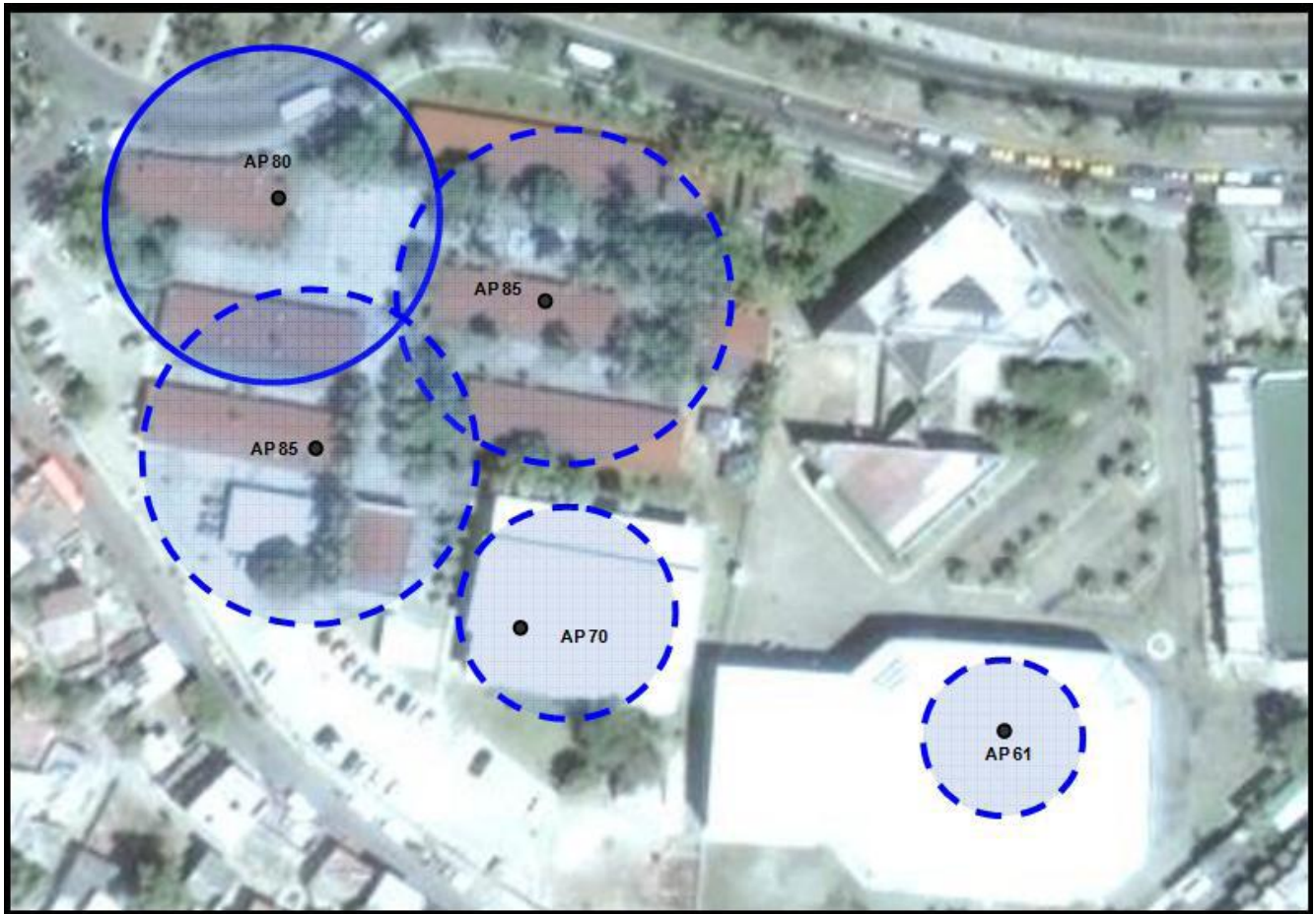
Figura 6. Distribución de antenas y equipamiento para el servicio de red inalámbrica Campus Manzanillo – San Pedro.
