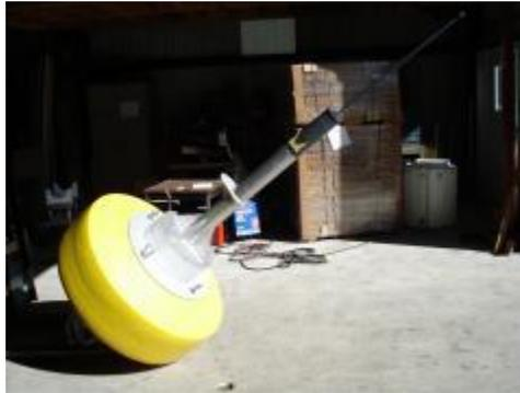
Equipo que será utilizado para medir la presión parcial del dióxido de carbono en aire y agua, así como la temperatura y salinidad de la superficie del mar.
