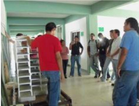
Ensayo de estructuras en un sismo
