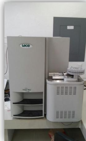
Técnica utilizada para detectar C,N e H, a través de la reacción de oxidación completa. Tiene su aplicación en la industria alimentaria y farmacéutica para el control de calidad de producto y materia prima.
