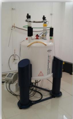
Técnica utilizada para estudiar la estructura molecular en solución y en solido de compuestos como; materiales, catalizadores, nanocompuestos, fármacos etc.
