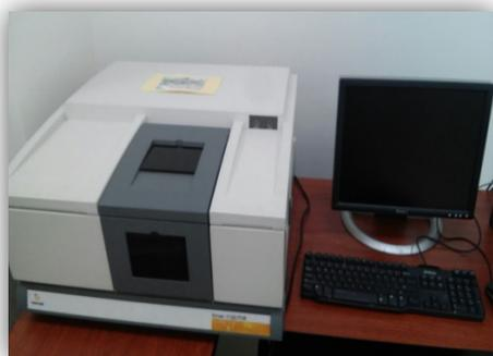
Técnica utilizada para determinar los grupos funcionales de una muestra en cualquier estado del material (líquido, sólido, gas), con aplicación principalmente en la industria de polímeros
