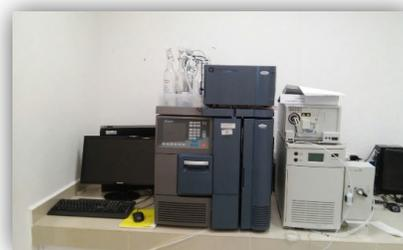
Técnica para separar componentes de una mezcla, utilizada para identificar y cuantificar contaminantes fenólicos, herbicidas, pesticidas, drogas,
