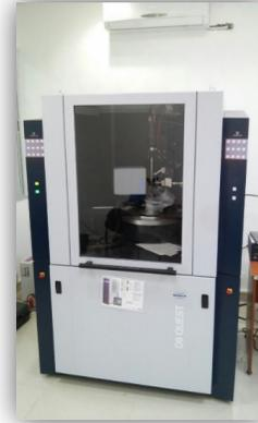
Técnica que se utiliza para detectar y elucidar la estructura cristalina. Se utiliza principalmente para investigación en áreas como: Diseño de nuevos fármacos, compuestos de coordinación, compuestos orgánicos cristalinos
