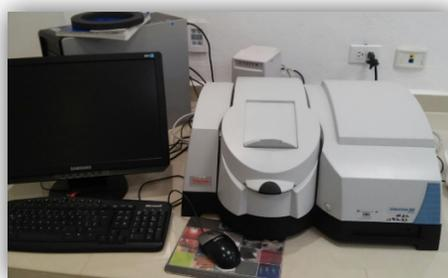
Técnica utilizada para medir la adsorción de la radiación ultravioleta-visible de una muestra. Se utiliza en disolución, para la identificación y concentración de compuestos orgánicos e inorgánicos
