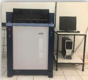
Técnica para determinar el contenido y la composición elemental, utilizada en la industria farmacéutica, geología, minera, materiales, análisis ambientales etc.
