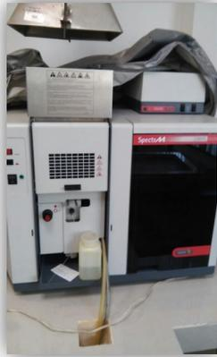
Técnica que detecta contaminación por metales en alimentos, productos farmacéuticos y agua en concentraciones del orden de ppm (mg/L). Elementos, tóxicos en altas concentraciones (Al, Ni, Cu, Zn, Se, Mo, Sn). Elementos esenciales (A altos niveles: Na, Mg, P, S, K, Ca, Fe, a bajos niveles: V, Cr, Co, Se, I). En leche, pan, carnes, pescado, vegetales, frutas, alimentos procesados, enlatados, congelados, ahumados, bebidas (refrescos, te, café, bebidas alcohólicas, suplementos nutricionales).
