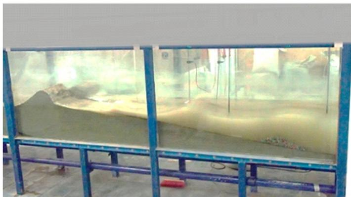
Canal de oleaje, equipo especializado del Instituto de Ingeniería de la UNAM, para la simulación en laboratorio sobre la dinámica de una costa. Dea Cárdenas Rojas. Noviembre 2017.
